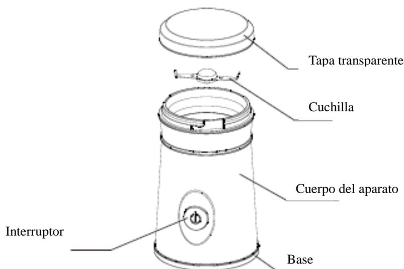
1. Tapa transparente, al ser transparente permita controlar el proceso de molido. Por su seguridad el molinillo solo funciona con la tapa correctamente cerrada.
